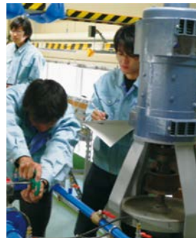
▲ポンプ性能試験 Pump performance test
