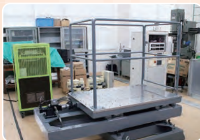
構造物振動台
